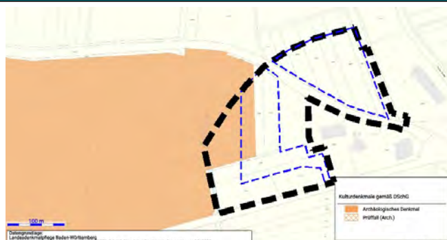
Archäologisches Denkmal gem. § 2 DSchG im Bereich des Plangebiets. Schwarz gestrichelt = BBP-Geltungsbereich. Blau gestrichelt = Bodenveränderungen durch gepl. Bau- und Verkehrsflächen
