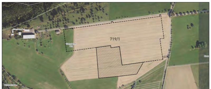
Bodenauftragsfläche (schraffierte Fläche) im Bereich des Flurstücks 719/1
